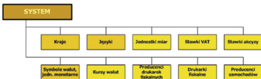
Rys. 4a. Słowniki ogólne systemu – słowniki na poziomie systemu, używane przez wiele aplikacji systemu. Słowniki: kraje, języki, symbole walut wykorzystują kodyfikację ISO i UE
