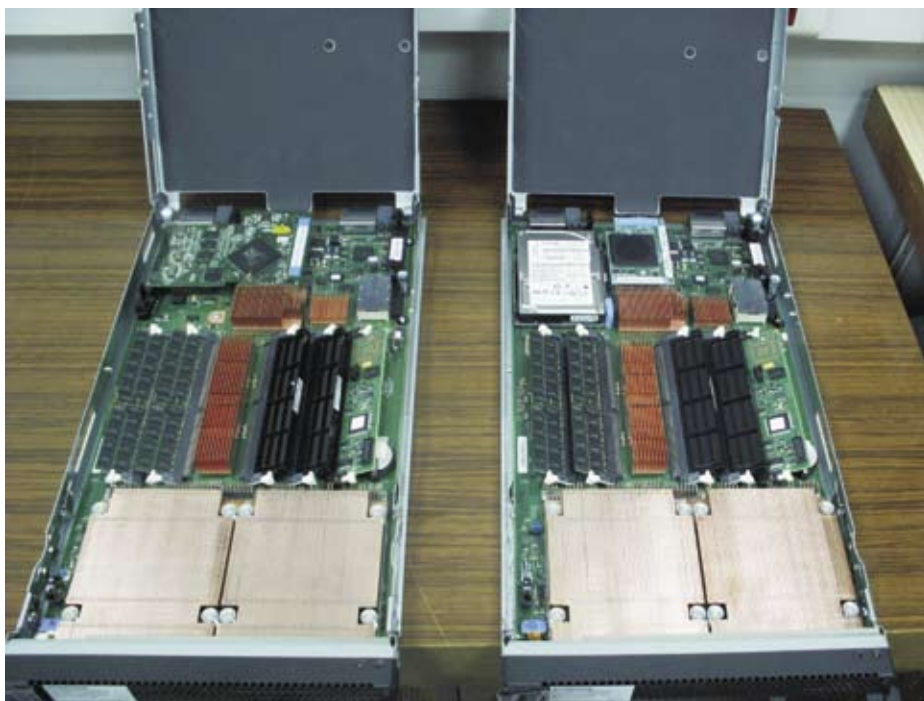
Fot. 21. Dwuprocesorowe serwery Blade z procesorami RISC POWER6 w konfiguracji bezdyskowej (po lewej) i z dyskiem twardym (po prawej)
